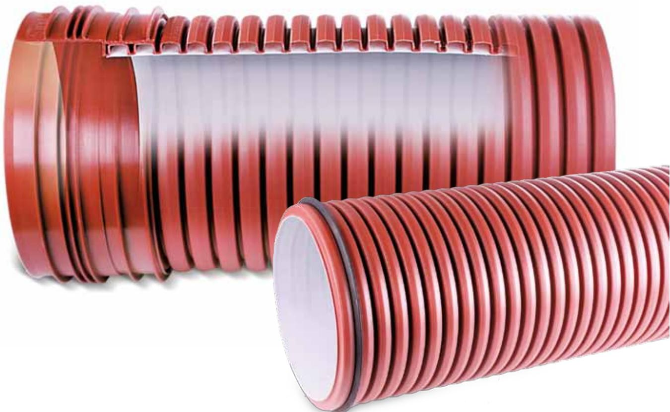
**Pragma®** и **Pragma® PRO16** – раstrубная труба с двойной структурированной стенкой, предназначенная для строительства безнапорных систем водоотведения. Трубы производятся из полипропилена-блоксополимера. Метод производства, двойная соэкструзия, когда одновременно изготавливаются внутренняя и наружная стенки, образующие на выходе из экструдера единое целое.
